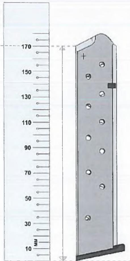
Магазин располагается вертикально на плоской поверхности, измерение производится от этой поверхности вверх до задней части губок магазина, как показано на рисунке. Разрешены только прямые, жёсткие магазины (то есть гибкие, барабанные, «J», «L», «Т»-образные и аналогичной формы магазины запрещены).
